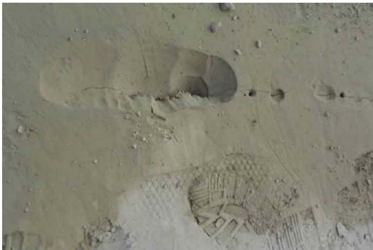
Fig. 26 – Dettaglio di un vulcanello di sabbia da liquefazione in via Giuseppe Verdi
